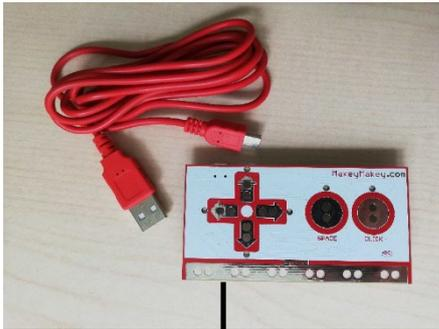
Ungefähr hier befindet sich etwas versteckt der Mikro USB-Port am Makey Makey
