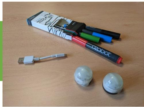
Ozobots sind kleine Roboter, die selbstgezeichneten Linien folgen können. Enthalten die Linien bestimmte Farbcodes, führen die Roboter verschiedene Befehle aus (bspw. eine Änderung der Geschwindigkeit, rückwärtsfahren...).
